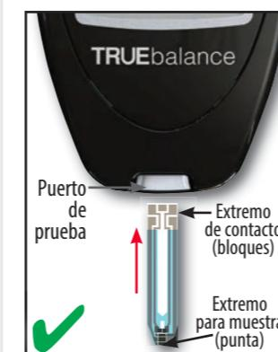
Con el medidor apagado, inserte la tira de prueba en el puerto de prueba con el extremo de contacto (bloques). El medidor se encenderá.
